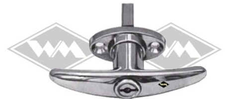
M109 Kreuzgriff verchromt mit Schließzylinder (incl. 2 Schlüssel) Grifflänge: 100 mm Lochabstand: 35 mm Vierkant: 8 x 8 mm
