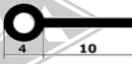
P8 PVC-Biese 4x10 mm transparent, weiß, rot, dkl.blau, grün, braun, grau, anthrazit, schwarz EUR 1,50/m*
