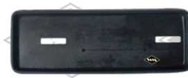
G12 Abdichtung Handbremshebel zw. Rahmen und Karosserie B/H ca. 19/7 cm EUR 19,00/St*
