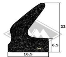
3321 Türabdichtung Abdichtung Wände/Decke Stabskoffer EUR 4,00/m*
