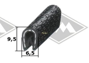
Kantenschutz PVC mit Metalleinlage Klemmbereich 1-2 mm KD426 weißgrau KD428 schwarz KD445 silber KD454 grau EUR 2,20/m*
