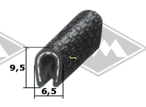
Kantenschutz PVC mit Metalleinlage Klemmbereich 1-2 mm KD426 weißgrau KD428 schwarz KD445 silber KD454 grau EUR 2,20/m*
