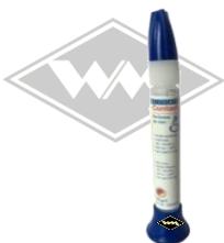
C12 WEICON VA1401 Verklebung von Metallen, Kunststoffen und Gummi, sowohl mittels auch untereinander mittelviskos, schnelle Aushärtung Pen 12 g
